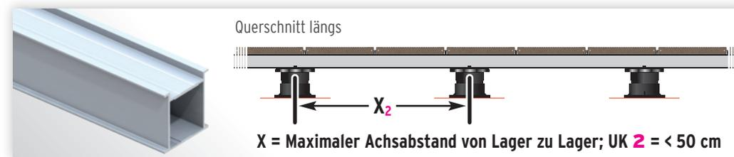
Terrassenlager **nur mit UK 40 x 40 mm** verwenden. Bei stark belasteten Terrassenflächen fixieren Sie jedes Terrassenlager mit zwei Betonschrauben 6 x 40 mm (Art. 4710, 40er-Set). Verwenden Sie außerdem stets unsere **schwingungsisolierenden Korkunterlagen** (Art. 2984) - jeweils eine pro Terrassenlager.
