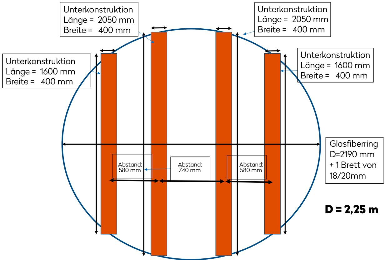
Wir empfehlen ein vollflächiges Fundament von 2250 x 2250 mm
