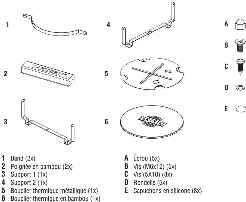
**ÉTAPE 1** - Fixez à la main le support 1 (3) au support 2 (4) avec une vis M6 (B), une rondelle (D) et un écrou (A).
