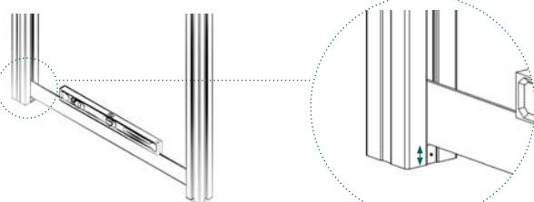
4 | Zuerst auf einer Seite das Distanzstück befestigen. Das Distanzstück der zweiten Seite mit Hilfe eines Füllungselementes und einer Wasserwaage ausrichten und befestigen.
