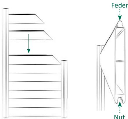
5 | Die Füllungselemente nacheinander von oben einschieben, dabei die Feder der Füllungselemente nach oben ausrichten.
