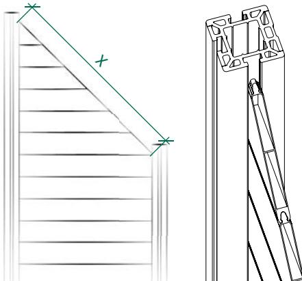
6a | Messen Sie die oben angegebene Länge. Bitte messen Sie immer von der Innenkante bis zur Innenkannte des Pfostens!
