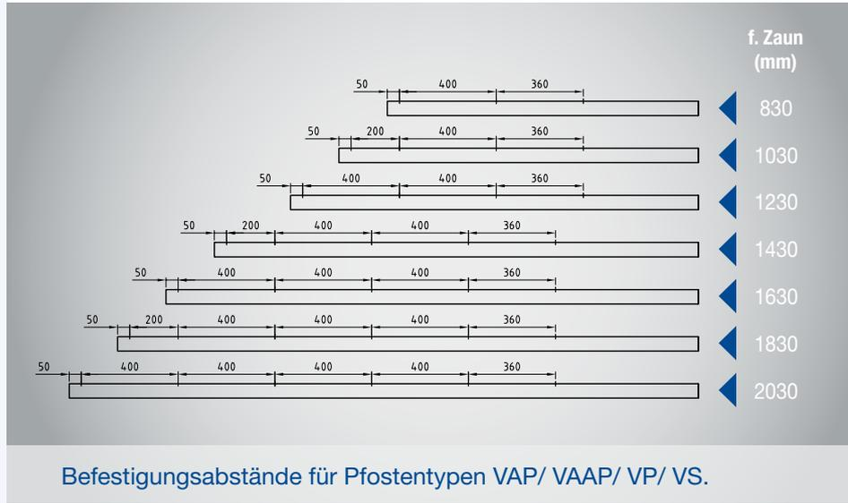
Befestigungsabstände für Pfostentypen VAP/ VAAP/ VP/ VS.
