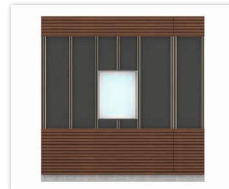
Dazu sollten entsprechende Z-Profile verwendet werden die gleichzeitig das Eindringen von Wasser von Oben in die Profile verhindert. Wenn zusätzlich eine Brandsperre beim Geschoßstoß erforderlich ist, können zusätzliche Maßnahmen erforderlich sein.
