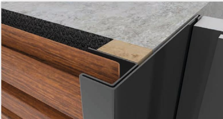
Bei der Montage der Fensterbänke und Leibungsprofile muss zu jeder Zeit sichergestellt sein das alle Bauteile ausreichend Luft und Abstand haben und sich getrennt voneinander ausdehnen können. Alle Anschlüsse und Laibungen müssen schlagregensicher ausgeführt werden.
