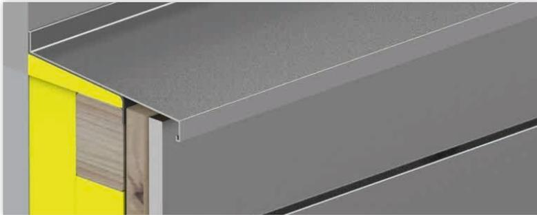
Für die Verkleidung der Fensterleibung sollten z.B. Metallprofile verwendet werden. Dabei sollte immer auf einen ausreichenden Abstand der Leibungsprofile zur Fensterbank geachtet werden. Der Abstand muss mindestens 10 mm betragen und zwischen dem Leibungsprofil und den Fassadenprofilen muss mindestens 5 mm Abstand eingeplant werden.
