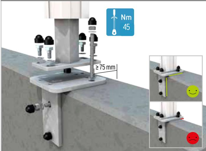
Mit den Montageadaptern können Sie eine LONGLIFE Sichtschutzanlage auf eine Betonmauer setzen. Die Adapter passen zum aufschraubbaren Pfostenträger. Mitgeliefert werden die Schrauben, Unterlegscheiben und Abdeckkappen für die Verbindung dieser beiden Elemente. Mindestabstand der Bohrungen zur Mauerkante 70 mm in jede Richtung. Bitte das Befestigungsmaterial für die Montage der Adapter an die Betonmauer separat besorgen.
