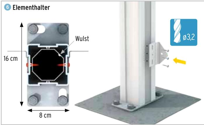
Nach dem Aushärten Pfostenanker aufschrauben.
