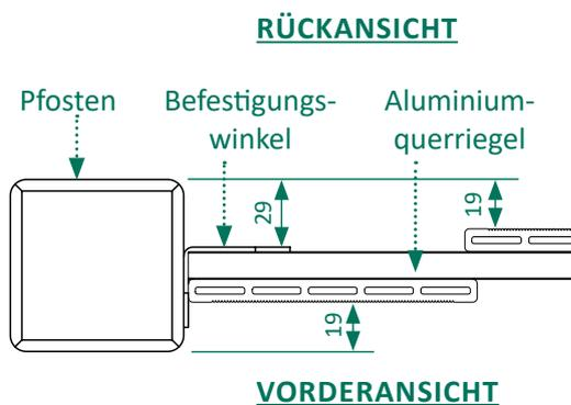
3a | Die Befestigungswinkel werden mit je zwei Schrauben am Pfosten und je zwei Schrauben an den Querriegeln der Zaunelemente befestigt. Die Befestigungswinkel mittig vom Querriegel anbringen.
