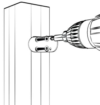
3b | Die Befestigungswinkel mit den mitgelieferten Schrauben am Pfosten befestigen. Die Schraublöcher mit einem 3 mm Bohrer vorbohren!
