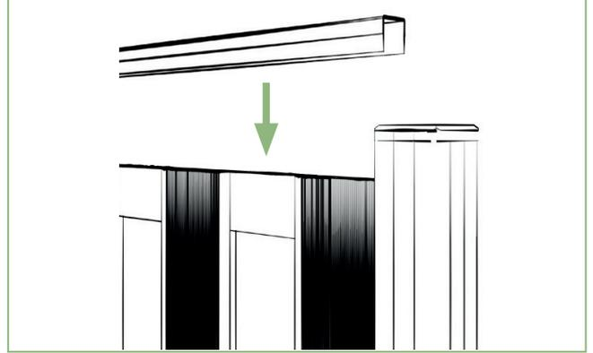
4 | Die Abdeckleiste von oben auf das Element setzen.
