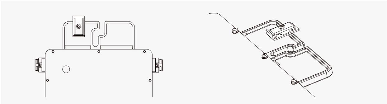
Verlegen Sie für jeden Mikrowechselrichter ein durchgehendes Erdungskabel durch die Erdungswinkel zu der den örtlichen Vorschriften entsprechenden AC-Erdungselektrode.
