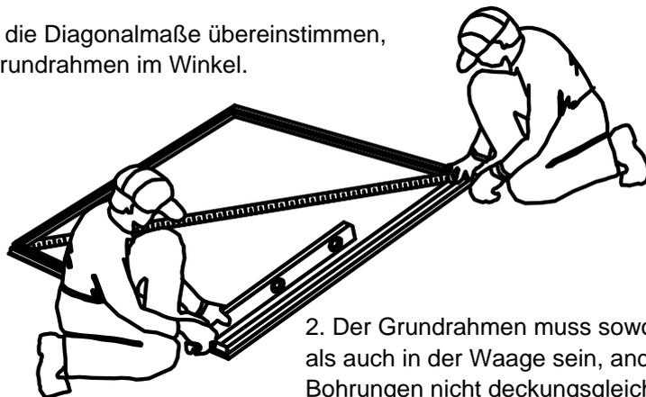
2. Der Grundrahmen muss sowohl im Winkel als auch in der Waage sein, andernfalls sind die Bohrungen nicht deckungsgleich.
