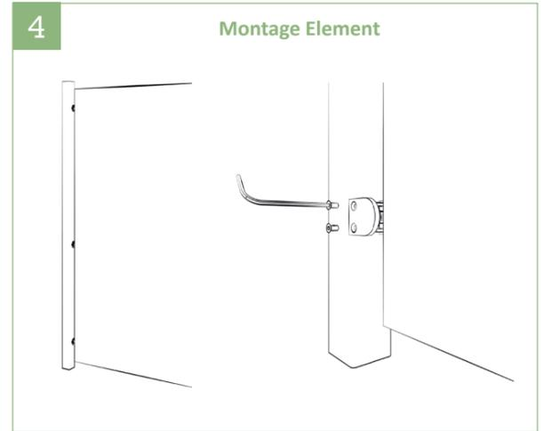
4 | Das Element mittig zwischen der Klemmbefestigung vorsichtig positionieren. Zum Schluss den Grundkörper der Klemmbefestigung mit zwei Innensechskantschrauben auf die Klemmbefestigung montieren.
