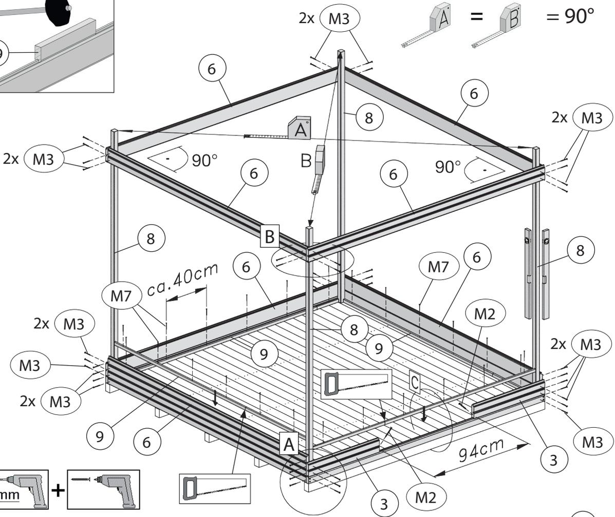
Die oberen Wandbohlen werden nur vorübergehend als Montagehilfe befestigt ( Abb.4), später wieder abgenommen und an anderer Stelle montiert. (Abb.5)
