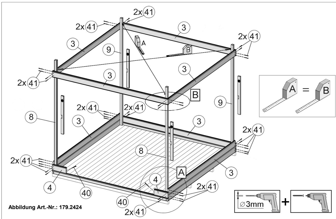
Die oberen Wandbohlen werden nur vorübergehend als Montagehilfe befestigt (Abb.4), später wieder abgenommen und an anderer Stelle montiert. (Abb.5)
