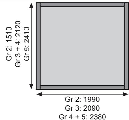
Fundamentplan (in mm) bei Aufbau mit Fußboden:
