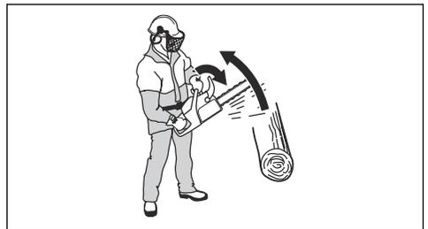
Bei weniger kräftigen Rückschlägen oder wenn sich der Rückschlagbereich der Schiene in der Nähe des Anwenders befindet, wird die Kettenbremse mit der linken Hand manuell betätigt.
