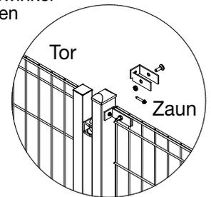
Befestigung der Zaunanschlusswinkel durch selbstschneidende Bohrschrauben am Torpfosten
