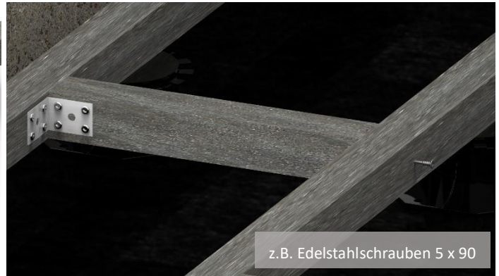
Bild 8. Der Abstand der Verstellfüße hängt von der Nutzung ab. Bild 9. Die Querstücke können mit Winkeln befestigt werden oder durch die längslaufende Unterkonstruktion geschraubt werden.
