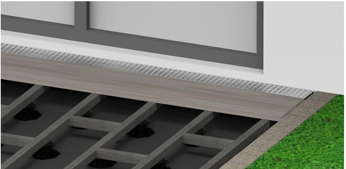
Bild 16. Entwässerungsroste bzw. Rinnen müssen bei geringeren Austrittshöhen < 150 mm eingebaut werden.
