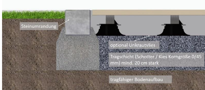
Bild 1. Die Tragschicht sollte ca. 20 cm stark sein.
