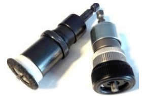
Bild 15. Vorsätze für eine gleichmäßige Schraubentiefe
