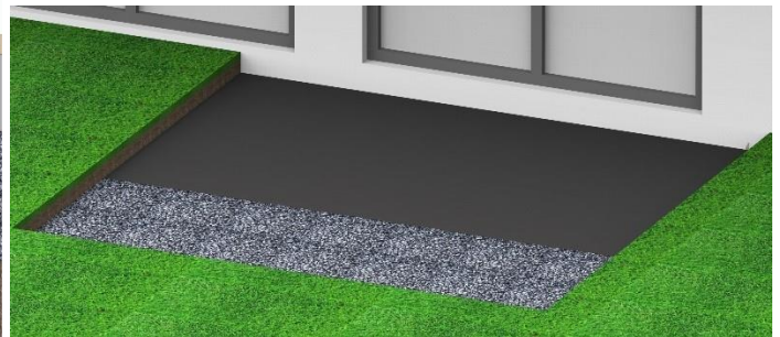
Bild 2. optional kann ein Unkrautvlies verwendet werden.
