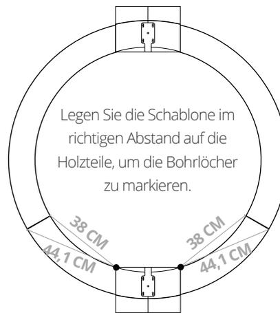
Legen Sie die Schablone im richtigen Abstand auf die Holzteile, um die Bohrlöcher zu markieren.
