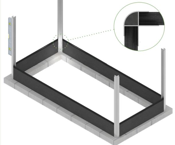
1 | Mit vier Füllungsprofilen beginnen (2x L=1460 mm, 2x L=660 mm). Die Füllungsprofile bis zum Anschlag in die Eckprofile stecken und dabei darauf achten, dass die Unterkanten bündig und lotrecht ausgerichtet sind.
