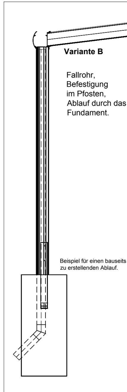
Fallrohr mit Schraubstutzen, Laubfangkorb und Rohrbogen zusammenstecken, ausrichten und verkleben. Mit Hilfe der Clip-Rohrschellen und den Schrauben (C101-025) montieren.
