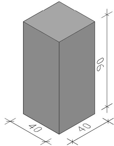
Messen Sie die Fundamente ein und heben Sie die Löcher entsprechend 90cm tief (frostfrei) aus.
