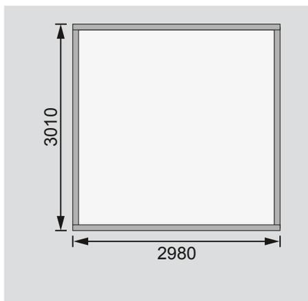
Fundamentplan mit Boden (in mm)
