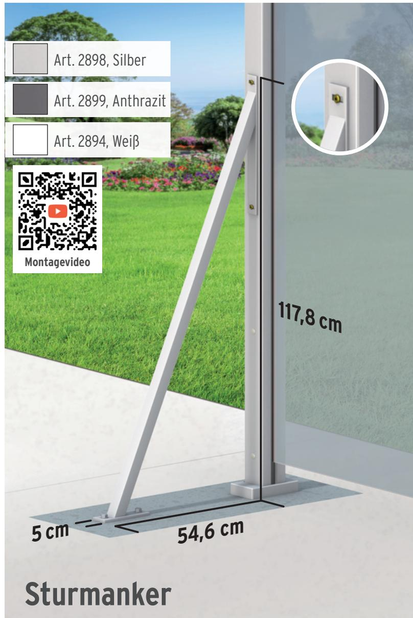
Windanker Plus und Sturmanker aus Stahl, mit angeschweißten Auflageflächen, verzinkt und farbig pulverbeschichtet, uerstreben jeweils 35 x 35 mm, inklusive Schlossschrauben und Muttern zur Montage an TraumGarten Pfosten (siehe Serien-Übersicht). Ebenso geeignet für alle gängigen Holz-Pfosten. Die Befestigung am Boden bitte separat erwerben. Die Montage dieser Spezialanker ist nicht an Metall-Torpfosten und SYSTEM Eckpfosten vorgesehen.
