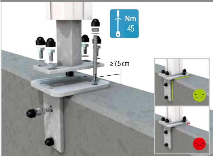
Mit dem Montageadapter können Sie eine Zaunanlage auf eine Betonmauer setzen. Der Adapter passt zum aufschraubbaren Pfostenträger. Mitgeliefert werden die Schrauben, Unterlegscheiben und Abdeckkappen für die Verbindung dieser beiden Elemente.
