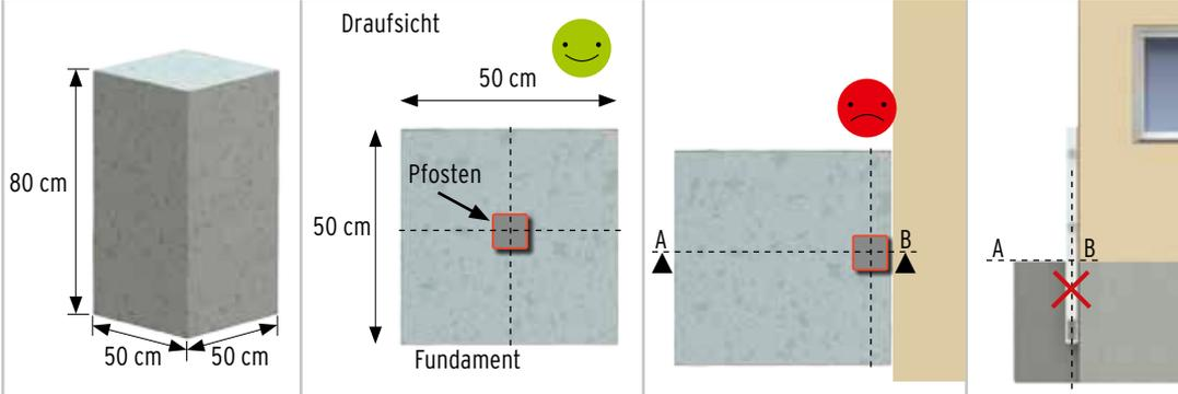
Als Baugrund werden die Bodenklassen 4-6 nach DIN 18300 vorausgesetzt. Bei Abweichungen der Bodenklasse, die Fundamente größer erstellen. Die Pfosten müssen **mittig** gesetzt werden. Ein dreieitiges Fundament ist nicht zulässig.
