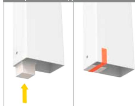
Auflaufklotz vor der Tormontage in die Führung einstecken und mit Kleband sichern. Erst nach dem Betonieren verschrauben (siehe S. 17).
