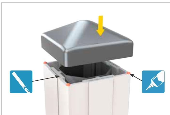
Vor Montage der Pfostenkappen alle Pfosten auf einen optisch gleichen Überstand zum Zaun kürzen und die Pfosten-Profile einklipsen.
