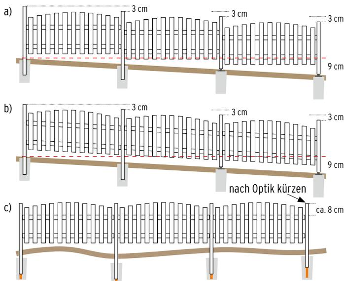
**Generell:** Je nach Grundstücksverlauf werden Pfosten mit größeren Längen als bei einem ebenen Einbau benötigt.
