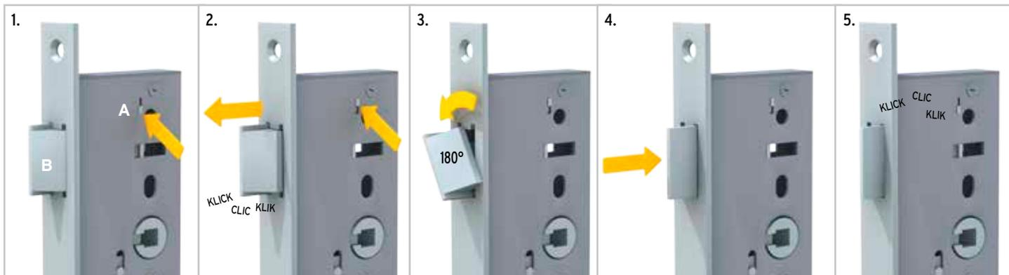
Das Einsteckschloss ist für DIN links und DIN rechts verwendbar. Dazu müssen Sie je nach Werkeinstellung die Falle im Schloss um 180° drehen:
