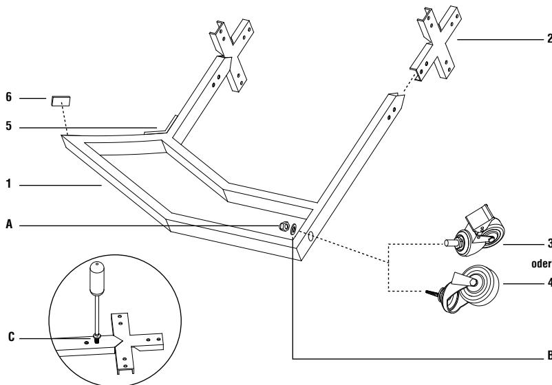
**SCHRITT 1** - Befestigen Sie 4x lange Dichtungen / Klebepads (5) und 4x kurze Dichtungen / Klebepads (6) an den 4x Standbeinteil (1) wie abgebildet. Stellen Sie sicher, dass die lange Dichtung (5) an der Innenseite des abgewinkelten Beinteils und die kurze Dichtung (6) am Ende des Standbeinteil (1) angebracht ist.
