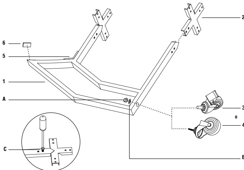
**PASO 1** - Coloque 4 juntas largas / almohadillas adhesivas (5) y 4 juntas cortas / almohadillas adhesivas (6) a las 4 secciones de patas verticales (1) como se muestra. Asegúrese de que la junta larga (5) esté colocada en el interior de la sección de la pata en vertical y la junta corta (6) esté colocada en el extremo de la sección de la pata vertical (1).
