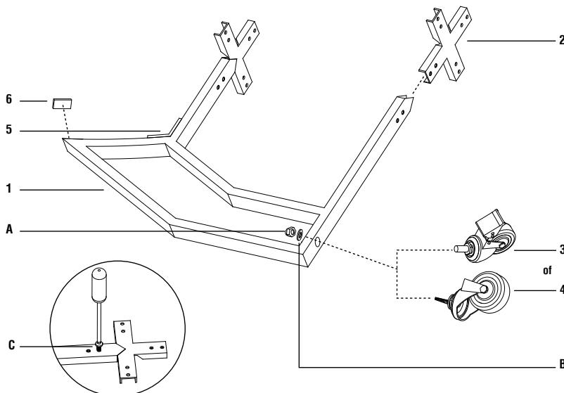
**STAP 1** - Bevestig 4x lange pakking/zelfklevende kussentjes (5) en 4x korte pakkingen/ zelfklevende kussentjes (6) aan de 4x stand poot secties (1), zoals aangegeven. Zorg ervoor dat de lange pakking (5) aan de binnenkant van het schuine gedeelte van de poot is bevestigd en dat de korte pakking (6) aan het uiteinde van het standaardpootgedeelte (1) is bevestigd.
