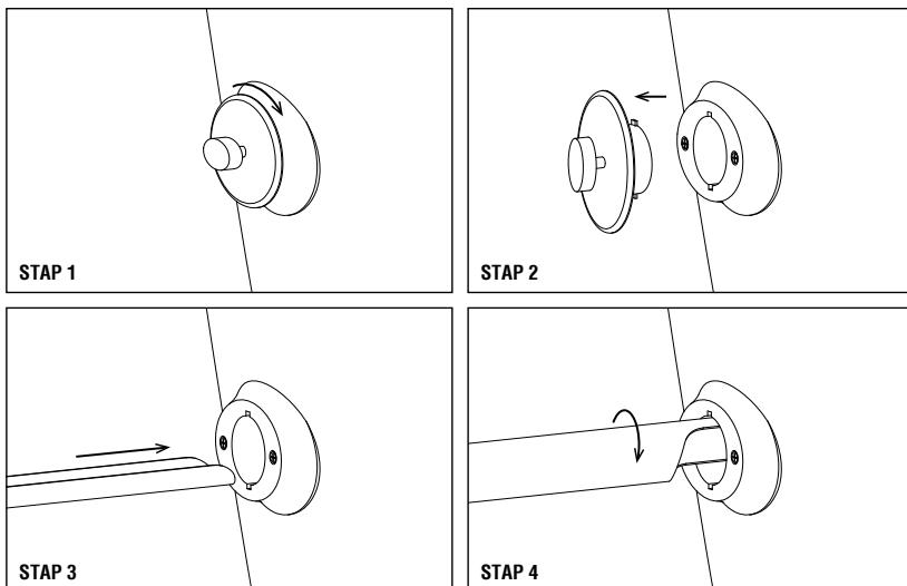
**STAP 1** - Draai de sluiting van de Woodchipper opening een kwartslag naar rechts.
