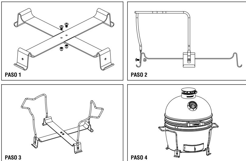
**PASO 1** - Inserte el tornillo (B) a través del orificio de ambas patas del carro (1,2) y luego apriete las tuercas ciegas (A) con la mano. (Nota: los tornillos deben mirar hacia abajo).
