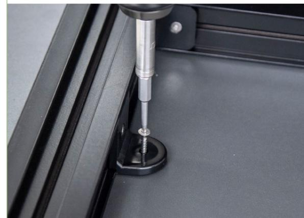
Bei Bedarf kann die Alu-UK auch direkt am Boden befestigt werden. Hierfür dienen die Befestigungswinkel. Sie sollten alle 500 mm angebracht werden.
