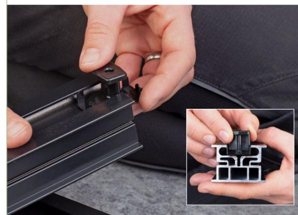
**3** Zur Befestigung der Dielen dienen die Universal-Clips. Diese werden ganz einfach in die UK-Schienen eingeschoben und gewährleisten so den nötigen Dehnungsabstand zwischen den Dielen.
