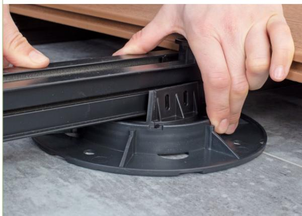
Zum Ausgleich von Gefällen kann die Alu-UK auf Verstellfüßen aufgebaut werden. Diese sind in fünf verschiedenen Höhen verfügbar und werden mit Schrauben an der Alu-UK befestigt.
