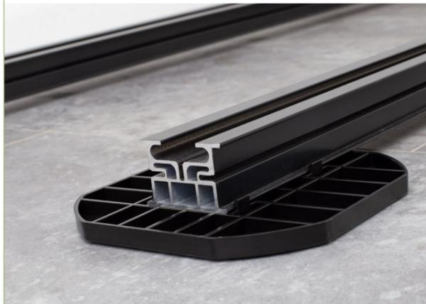
**1** Die Alu-UK wird in einem Abstand von 350 mm, gemessen von Mitte UK bis Mitte UK (Achismaß) verlegt. Für einen besseren Halt, können die Bodenplatten verwendet werden.
