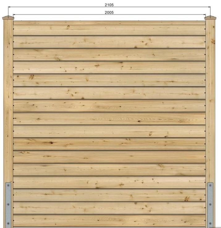
Tipp: Ermitteln Sie die genauen Pfostenabstände durch Einlegen eines Profils in die Pfostennuten. Achten Sie darauf, dass das Profil gerade liegt. Hierzu sind z.B. Hilfsklötzchen (Höhe 2,5 cm) zum Unterlegen unter das Profil hilfreich.
