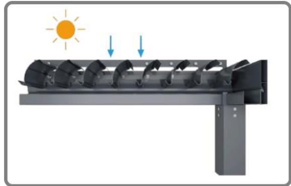
Da heiße Luft aufsteigt, können die Lüftungsschlitze teilweise geöffnet bleiben. Kippen Sie die Lamellen so, dass die Sonne blockiert wird, aber die warme Luft durch die Öffnung an den Lamellen entweichen kann, wodurch der überdachte Raum kühl bleibt.
