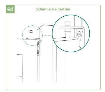
4d | Das Tor aufrichten und die Sechskantschraube mit der Kunststoffunterlegscheibe (zwischen Scharnier und Torrahmen) einschrauben. Die Schraube so eindrehen, dass der Kopf der Schraube im Winkel verschwindet.
