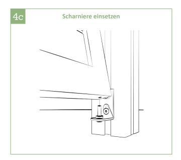
4c | In die Unterseite des Tores die Sechskantschraube mit Gleitlager und Metallunterlegscheibe einschrauben und in das untere Scharnier einsetzen.
