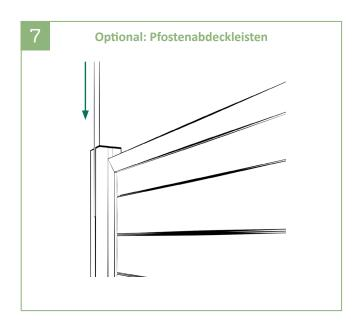
7 | Die Pfostenabdeckleisten von oben in die Pfostennut einschieben und mit der Unterkante des Pfostens bündig abschließen.
