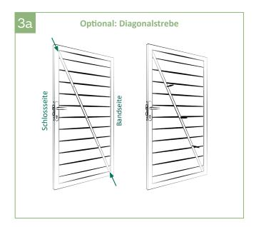
3a | Diagonalstrebe auf der gewünschten Seite des Tores positionieren. Von unten Bandseite, nach oben Schlossseite! Alle drei Löcher anzeichnen und Diagonalstrebe wieder herausnehmen.
