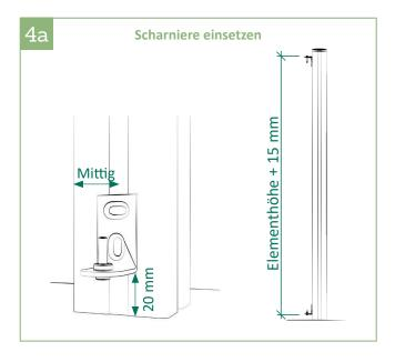
4a | Unteres Scharnier 20 mm vom Boden mittig auf den Pfosten setzen. Pro Loch mit 3 mm, danach mit 7 mm vorbohren und anschließend mit einem M8 Gewindeschneider nachsetzen, Schrauben eindrehen. Der Abstand zwischen Oberkante des oberen Scharnieres und Unterkante des unteren Scharnieres beträgt 1815 mm.
