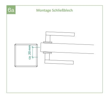
6a | Das Tor ca. 20 mm öffnen, damit sich der Anschlag noch montieren lässt. Den Anschlag zwischen Pfosten und Torelement halten, um den richtigen Abstand zu bestimmen.
