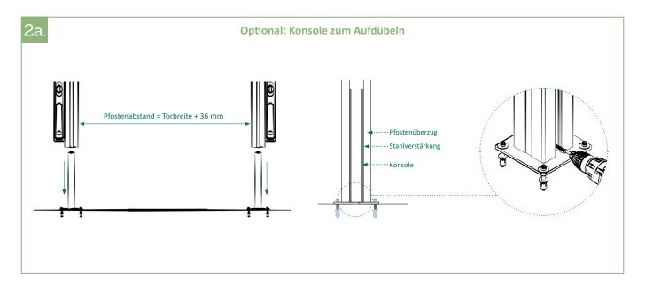
2a | Ausrichtung der Konsolen bei aufgesteckten Pfosten, danach aufdübeln. Der Pfostenüberzug und die Stahlverstärkung schließen nach dem Aufsetzen des Pfostens bündig ab.\*
