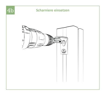
4b | Oberes Scharnier mit dem vorgegebenen Abstand vom unteren Scharnier befestigen. Pro Loch mit 3 mm, danach mit 7 mm vorbohren und anschließend mit einem M8 Gewindeschneider nachsetzen, Schrauben eindrehen.
