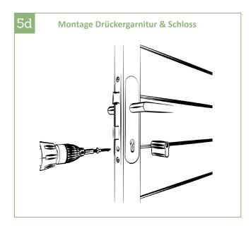
5d | Schließzylinder einsetzen und verschrauben.
