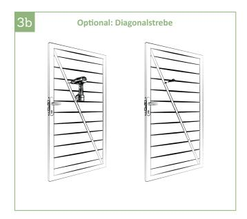
3b | Mit einem 4,5 mm Bohrer durch die erste Wandung der WPC- Füllung bohren, dann die Kunststoffdübel vorsichtig bündig einschlagen. Die Diagonalstrebe wieder einsetzen und mit den mitgelieferten Schrauben von Hand befestigen.
