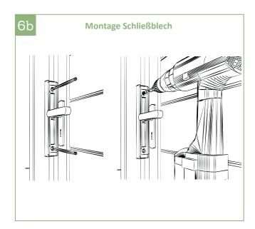
6b | Um die Position des Anschlages festzulegen, müssen Markierungen auf den Pfosten angezeichnet werden. Die Löcher zuerst mit einem 3 mm, danach mit einem 7 mm Bohrer vorbohren und dann mit einem M8 Gewindeschneider nachsetzen. Schrauben eindrehen.
