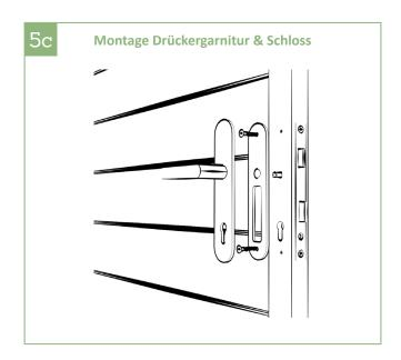
5c | Gegenüberliegend die Drückerbefestigung verschrauben und die Drückerblende aufstecken.
