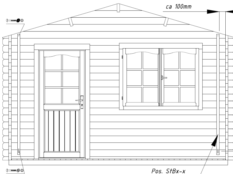
Montering av stormavstivere:
