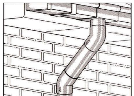
Bei Dachüberständen wird das Fallrohr mittels zwei Bögen an die Hauswand geführt. Die Rohrbögen so montieren, dass die Pfeilmarkierung in Ablaufrichtung des Wassers zeigt.
