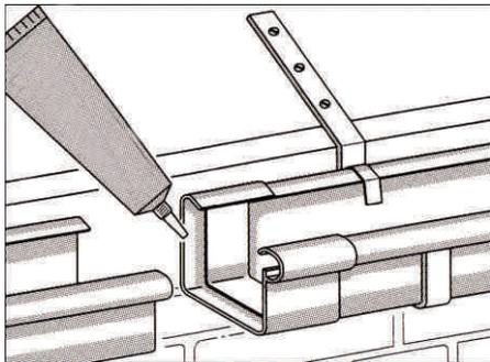
Die Montage an der höchsten Stelle beginnen. Ein zwei Meter langes Rinnenstück zunächst vorn an den Kunststoff Rinnenhaken einhängen, dann nach hinten einklipsen. Bei Verwendung von Rinneisen wird die Rinne ebenfalls vorn eingehängt und durch das Einbiegen der hinteren Metalllasche befestigt.
