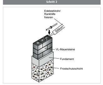
Die Vario-Line®-Einsatzsteine sind an der gewünschten Stelle einzusetzen. Dabei ist zu beachten, dass die gegenüberliegenden Steine flucht- und waagerecht eingebaut werden. Vor Einlegen der Rankhilfe sollte die vordere Nut des Einsatzsteines mit Silikon ausgekleidet werden. Falls vorher noch nicht geschehen, werden jetzt die Rosetten mit Blindstopfen auf die Rankhilfe geschoben. Die Rankhilfe wird dann in die vordere Nut eingelegt. Die Rankhilfe sollte ca. 10 cm in den Stein reinragen.
