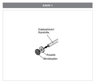
Vor Einsatz der Vario-Line®-Edelstahlrohren/Rankhilfen sind die Rosetten von beiden Seiten mit der offenen Seite sowie die Blindstopfen nach Außen auf die Rankhilfe aufzusetzen. Der Blindstopfen wird zum Ausfüllen der einzelnen Rosette genutzt, um die Verklebung zu vereinfachen.
