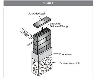
Die Mauersteine sind schichtweise mit erdfeuchtem Beton (präferiert aus Trasszement-Basis) zu verfüllen. So ist mit jeder weiteren Mauer-Schicht zu verfahren. Nach Fertigstellung der Mauer werden die Rosetten inkl. der Blindstopfen rechts und links mit einem Montagekleber befestigt.
