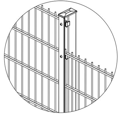
Bei einem Gefälle von mehr als 10 %, wird eine Teilung des Gitters empfohlen. Für jede Gitterteilung ist ein zusätzlicher Pfosten erforderlich.
