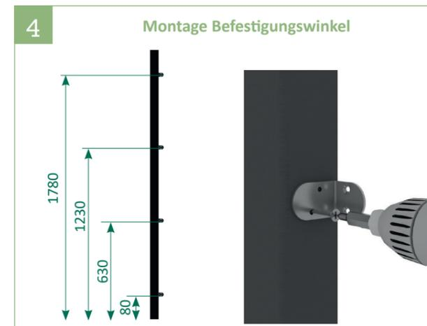
4 | Position der Befestigungswinkel entsprechend der Maßangaben markieren dabei darauf achten, dass das Zaunelement mittig zum Pfosten positioniert ist. Anschließend mit einem 3 mm Bohrer vorbohren (nicht im Set enthalten). Die Befestigungswinkel mit den selbstschneidenden Schrauben  $\varnothing$  3,9 x 25 mm mit einem Kreuzschlitz-Bit PH 2 am Pfosten montieren.
