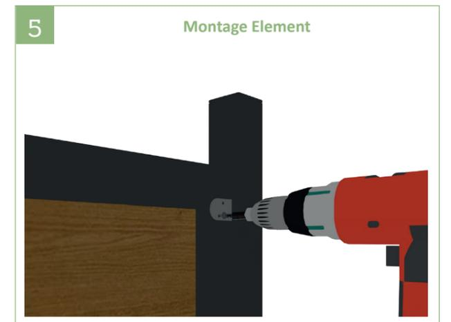
5 | Nach der Montage aller Befestigungswinkel wird das Zaunelement mit jeweils zwei selbstschneidenden Schrauben  $\varnothing$  3,9 x 13 mm pro Befestigungswinkel mit einem Kreuzschlitz-Bit PH2 rückseitig befestigt.
