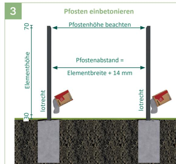
3 | Anschließend die Pfosten setzen und ausrichten. Das Erdloch komplett mit Beton füllen und verdichten. Beton nach Herstellerangaben aushärten lassen.
