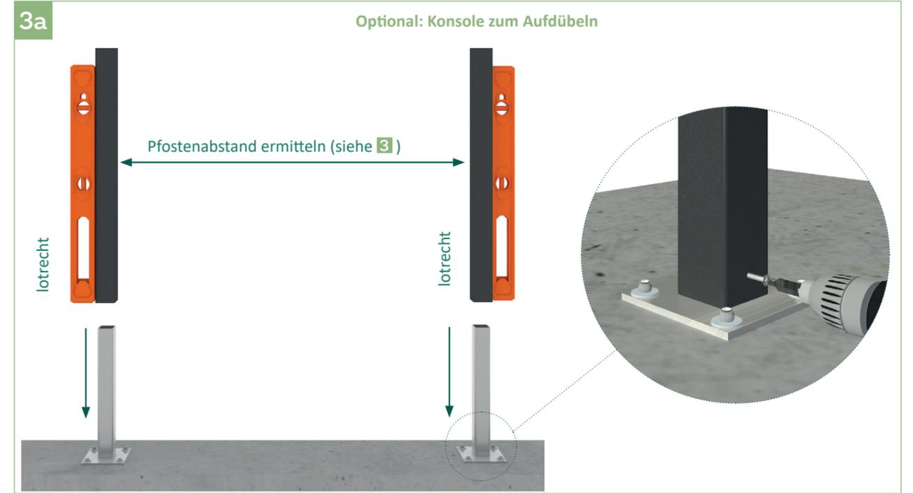
3a | Ausrichtung der Konsolen bei aufgesteckten Pfosten. Zum Befestigen der Konsolen auf den Untergrund die Pfosten entfernen. Zusätzlich kann der Pfosten durch eine Senkkopfschraube fixiert werden. Schrauben sind nicht im Lieferumfang enthalten.
