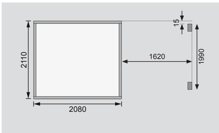
Fundamentplan mit Boden (in mm)
