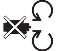
Rotierendes Schneidwerkzeug Niemals bei laufendem Motor die Hand oder den Fuß unter die Haube halten
