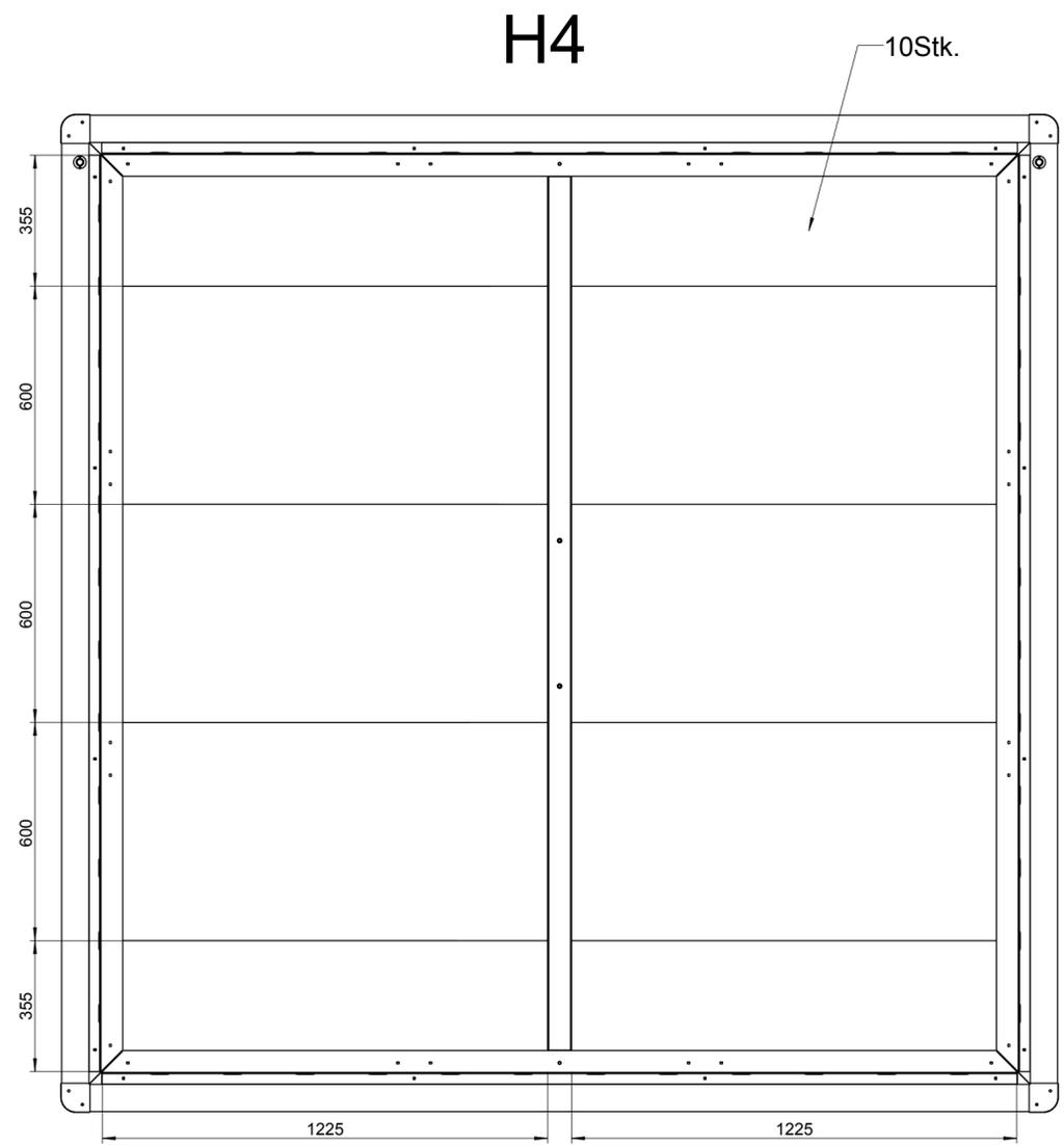
Das Abmaß der Styrodurplatte für die Isolierung beträgt 1250x600x30.
