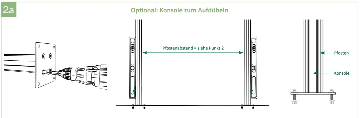
2a | Konsolen in die Pfosten stecken und mit den mitgelieferten Schrauben von unten fest verschrauben (nur bei dafür vorgesehenen Pfosten). Ausrichtung der Konsolen bei aufgesteckten Pfosten, danach auf den Untergrund aufdübeln. Die Pfosten schließen nach dem Aufsetzen bündig mit den Konsolen ab.
