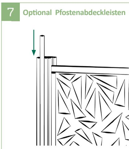
7 | Die Pfostenabdeckleisten von oben in die Pfostennut einschieben und mit der Unterkante des Pfostens bündig abschließen.
