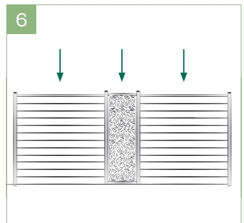
6 | Bei der Montage des XL-Designersatzes in Kombination mit anderen Wind- und Sichtschutzelementen des GroJa Produktsortiments auf eine gleichmäßige Höhe achten.
