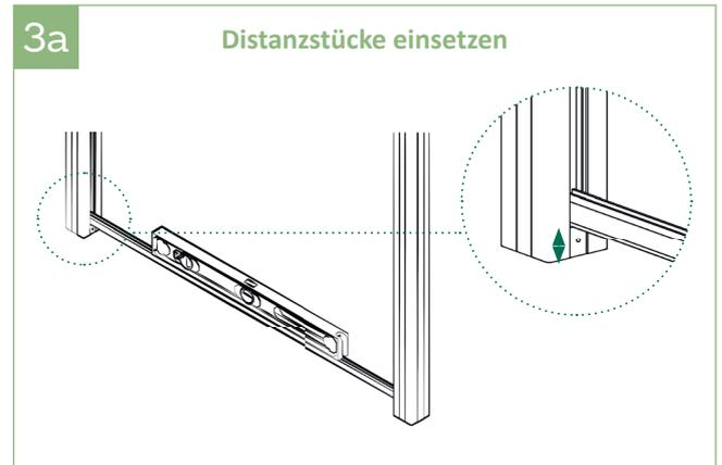
3a | Zuerst auf einer Seite das Distanzstück befestigen. Das Distanzstück der zweiten Seite mit Hilfe einer Leiste und einer Wasserwaage ausrichten und befestigen.
