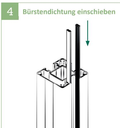
4 | Jeweils zwei der mitgelieferten Bürstendichtungen in die Pfostennuten einschieben.
