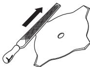
Die korrekte Schränkung der Sägeklinge beibehalten! Befolgen Sie unsere Anweisungen und verwenden Sie das empfohlene Schränkwerkzeug. Eine falsch geschränkte Sägeklinge erhöht das Risiko für das Festfahren und für Rückschläge sowie Schäden an der Klinge.
