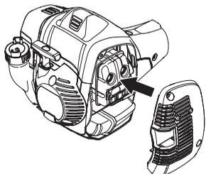
Nekateri modeli dušilcev so opremljeni s posebno mrežico za gašenje isker. Če je vaš stroj opremljen s dušilcem tega tipa, morate mrežico enkrat tedensko očistiti. V ta namen uporabljajte žično krtačo. Na dušilcih brez katalizatorja je mrežico za lovljenje isker priporočljivo očistiti in po potrebi
