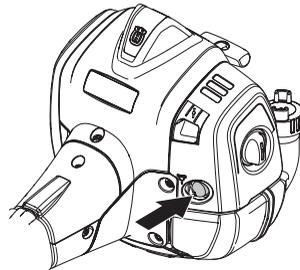
**Choke:** Den Chokehebel in Choke-Lage führen.
