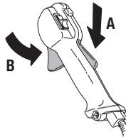
Kontrollieren, ob der Gashebel in Leerlaufstellung gesichert ist, wenn sich die Gashebelsperre in Ausgangsstellung befindet.
