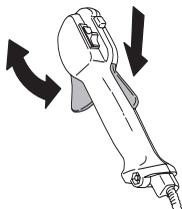
Glej poglavje pod naslovom Vžig. Vžigite stroj in mu dajte polni plin. Izpustite plinsko ročico in se prepričajte, da se rezilni priključek ustavi in obmiruje. Če se rezilni priključek vrti, ko je plinska ročica v legi prostega teka, preglejte nastavitve uplinjača v prosti legi. Glejte navodila v poglavju Vzdrževanje.
