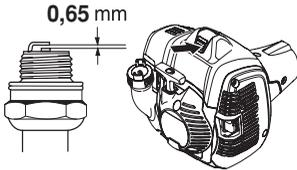
**ACHTUNG!** Stets den vom Hersteller empfohlenen Zündkerzentyp verwenden! Eine ungeeignete Zündkerze kann Kolben und Zylinder zerstören. Dafür sorgen, dass die Zündkerze eine sog. Funkenstörung hat.
