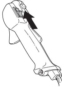
**ACHTUNG!** Der Stoppschalter geht automatisch in die Startstellung zurück. Um ein ungewolltes Starten zu vermeiden, muss bei Montage, Kontrolle und/oder Wartung daher stets die Zündkappe von der Zündkerze entfernt werden.
