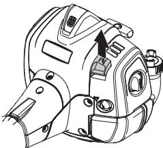
Das Luftfiltergehäuse demontieren und den Filter herausnehmen. Den Filter in warmer Seifenlauge waschen. Mithilfe von Druckluft oder einer Bürste auch das Innere des Filterdeckels reinigen. Dafür sorgen, dass der Filter trocken ist, wenn er wieder montiert wird.
