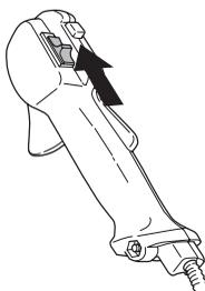
Vžigite motor in preverite, če se ustavi, ko izklopno stikalo potisnete v položaj STOP.
