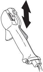
Kontrollieren, ob Gashebel und Gashebelsperre mit dem dazugehörigen Rückzugfedersystem leicht funktionieren.
