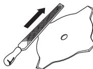
Skrbite za pravilen nagib brušenja žaginega lista! Sledite našim navodilom in uporabljajte orodje za brušenje nagiba, ki ga priporočamo. Nepravilno nabrušen nagib žaginega lista veča nevarnost zažaganja, odsunka in poškodb žaginega lista.
