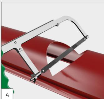
An der Stelle, an der das Fallrohr über den Einhangstützen an die Dachrinne angeschlossen werden soll, muss in die Dachrinne ein Loch mit einer Säge oder Blechscheren geschnitten werden.
