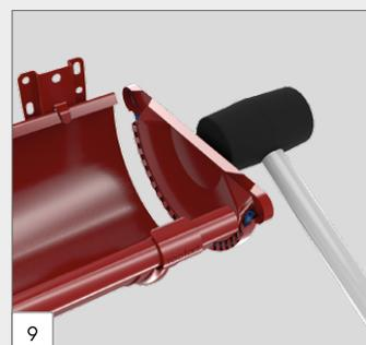
Die Steckböden mit Dichtlippe (CU) werden an den Dachrinnenenden mit Hilfe eines Gummihammers ohne Silicon befestigt. Silicon führt zur Zerstörung der Dichtung!
