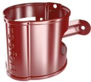
Zur Befestigung der Fallrohre an der Gebäudefassade „Click“ Verriegelungssystem Dreifache Befestigungsmöglichkeit je nach Fassadenart, entweder an zwei seitlichen Ohren, zentral mit Dübel oder vertikal mit Blindnieten (an Mauerwerk mit Wärmeschutz oder Metallverkleidung) Verdeckt die Verbindungsstellen zwischen zwei Fallrohren
