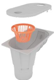
Leitet das Niederschlagswasser direkt in ein Entwässerungssystem oder Sammelbehälter. Ermöglicht die Luftzirkulation aus der Abwasserleitung zum Fallrohr ( verhindert damit ein Einfrieren des Wassers im Fallrohr) Durch ein Sieb werden Schmutz und Blätter abgefangen. Die Notwendigkeit einer Reinigung der Abwasserrohre wird dadurch reduziert. Farbvarianten: Grau, Braun, Schwarz
