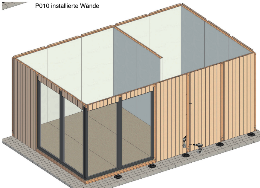
P010 installierte Wände
