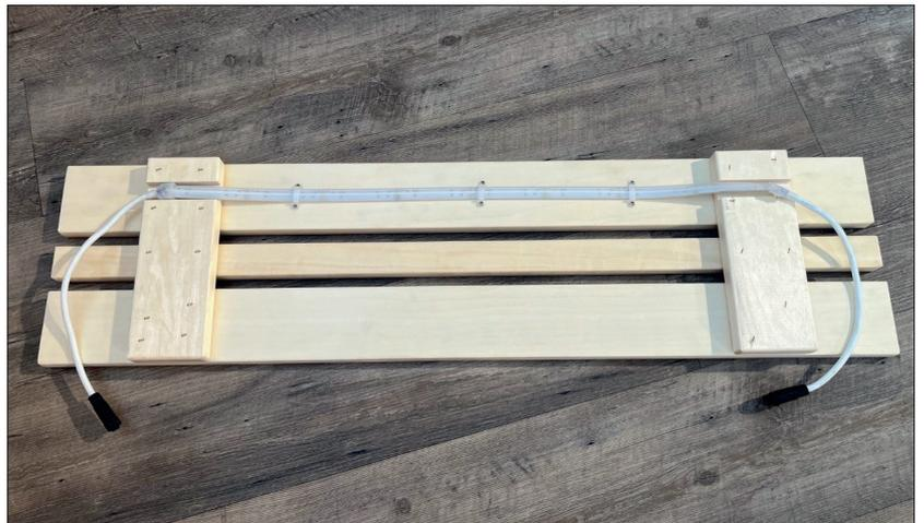
Ausfräsung für LED-Streifen (H x T = 20 x 10 mm)
