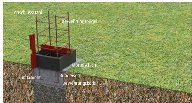
Die erste Schicht der Elemente muss absolut fluchtrett und waagrecht in eine Zementmörtelschicht verlegt werden (hiernach ist eine Ruhepause ratsam).
