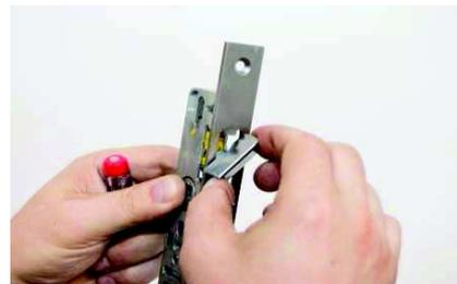
Hier lässt sich die Falle drehen und somit das Einsteckschloss für beide Richtungen verwenden.
