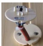
4. Signalleitung des Fühlers gemäß Anschlussplan an die Platine anschließen.
