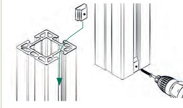
3 | Distanzstück hochkant in die Innenseite der Pfostennut einschieben, bündig mit der Unterkante des Pfostens abschließen, vorbohren und verschrauben.
