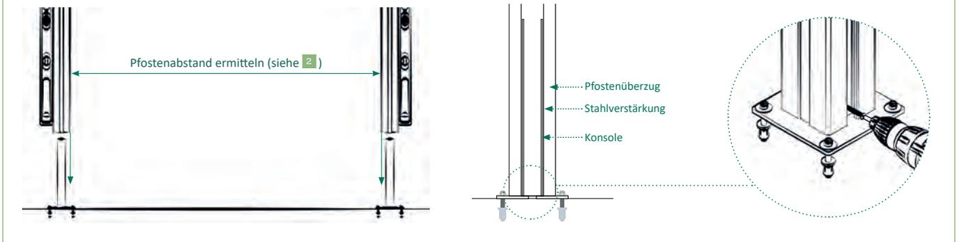
2a | Ausrichtung der Konsolen bei aufgesteckten Pfosten, danach aufdübeln. Der Pfostenüberzug und die Stahlverstärkung schließen nach dem Aufsetzen des Pfostens bündig ab.\*
