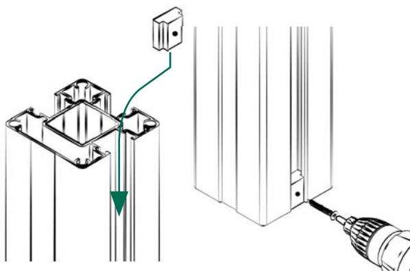
3 | Distanzstück hochkant in die Innenseite der Pfostennut einschieben, bündig mit der Unterkante des Pfostens abschließen, vorbohren und verschrauben.
