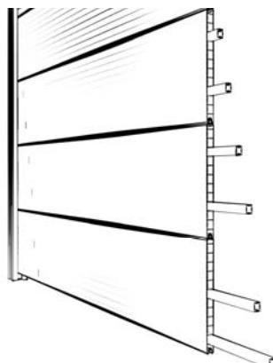
5a | Die Verstärkung in der ersten Füllung im unteren und mittleren Bereich einführen. Die Abstände der Verstärkung für das zweite und dritte Steckzaunprofil jeweils dritteln.
