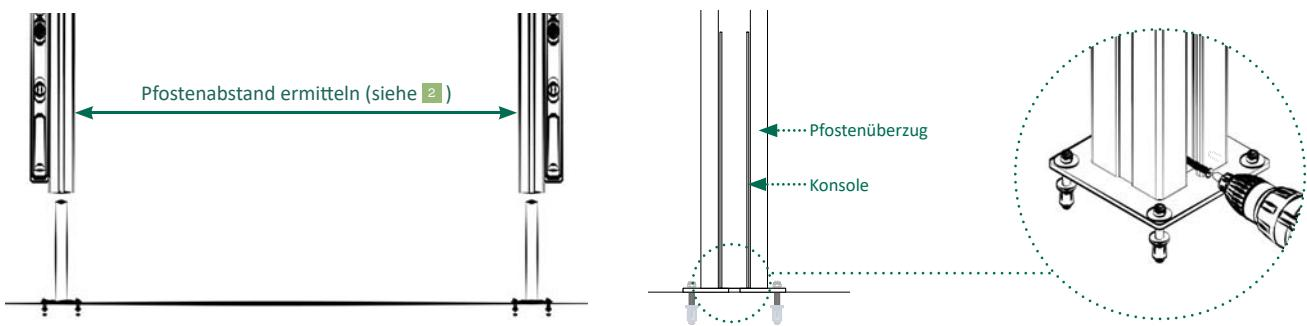
2a | Ausrichtung der Konsolen bei aufgesteckten Pfosten, danach aufdübeln.
