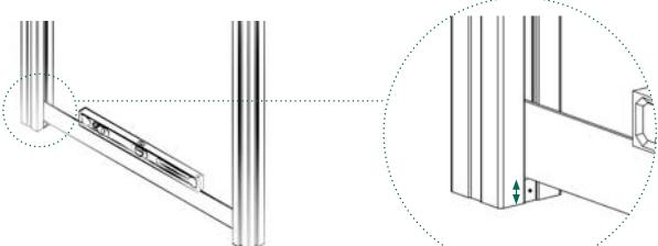
4 | Zuerst auf einer Seite das Distanzstück befestigen. Das Distanzstück der zweiten Seite mit Hilfe eines Füllungselementes und einer Wasserwaage ausrichten und befestigen.
