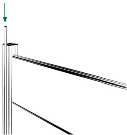
7 | Die Pfostenabdeckleisten von oben in die Pfostennut einschieben und mit der Unterkante des Pfostens bündig abschließen.
