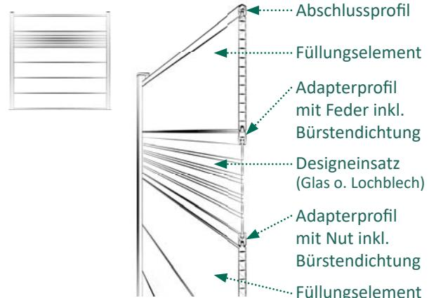
6a | Die Füllungselemente nacheinander von oben einschieben, dabei die Feder der Füllungselemente nach oben ausrichten. Bei der Montage des Designeinsatzes folgende Reihenfolge beachten: Adapterprofil mit Nut, Designelement, Adapterprofil mit Feder. Danach ein Füllungselement einschieben und das Abschlussprofil aufsetzen.
