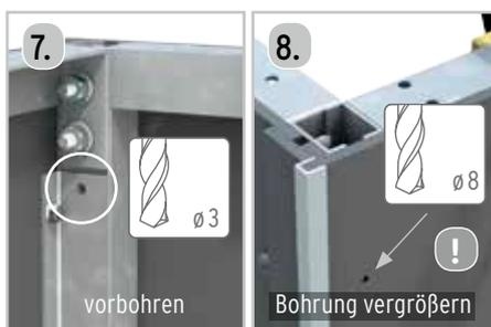
**Wichtig:** Die 8 mm Bohrungen sind Gleitpunkte für die Ausdehnung des Materials. Schrauben nicht zu fest anziehen (Nm 1,4)!
