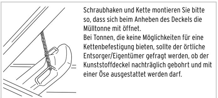
Schraubhaken und Kette montieren Sie bitte so, dass sich beim Anheben des Deckels die Mülltonne mit öffnet. Bei Tonnen, die keine Möglichkeiten für eine Kettenbefestigung bieten, sollte der örtliche Entsorger/Eigentümer gefragt werden, ob der Kunststoffdeckel nachträglich gebohrt und mit einer Öse ausgestattet werden darf.
