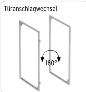
Der Rahmen ist für für einen **Türanschlag** DIN links und DIN rechts ausgelegt. Für einen Türanschlagwechsel die beiden Seitenrahmen um 180° drehen.
