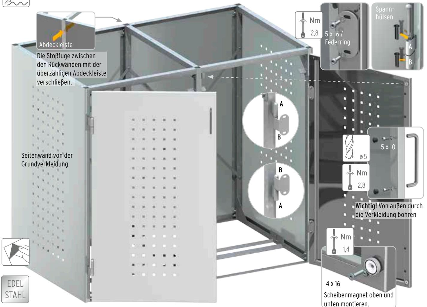
**Vorabkontrolle:** Entfernen Sie die Schutzfolien. Kontrollieren Sie die Elemente auf sichtbare Schäden. Prüfen Sie vorab, ob die gelochten Abdeckleisten auf die Bänder passen oder ob die Ausstanzungen eventuell mit einem Winkelschleifer (mit dünnem Metallblatt) leicht nachgefräst werden müssen.
