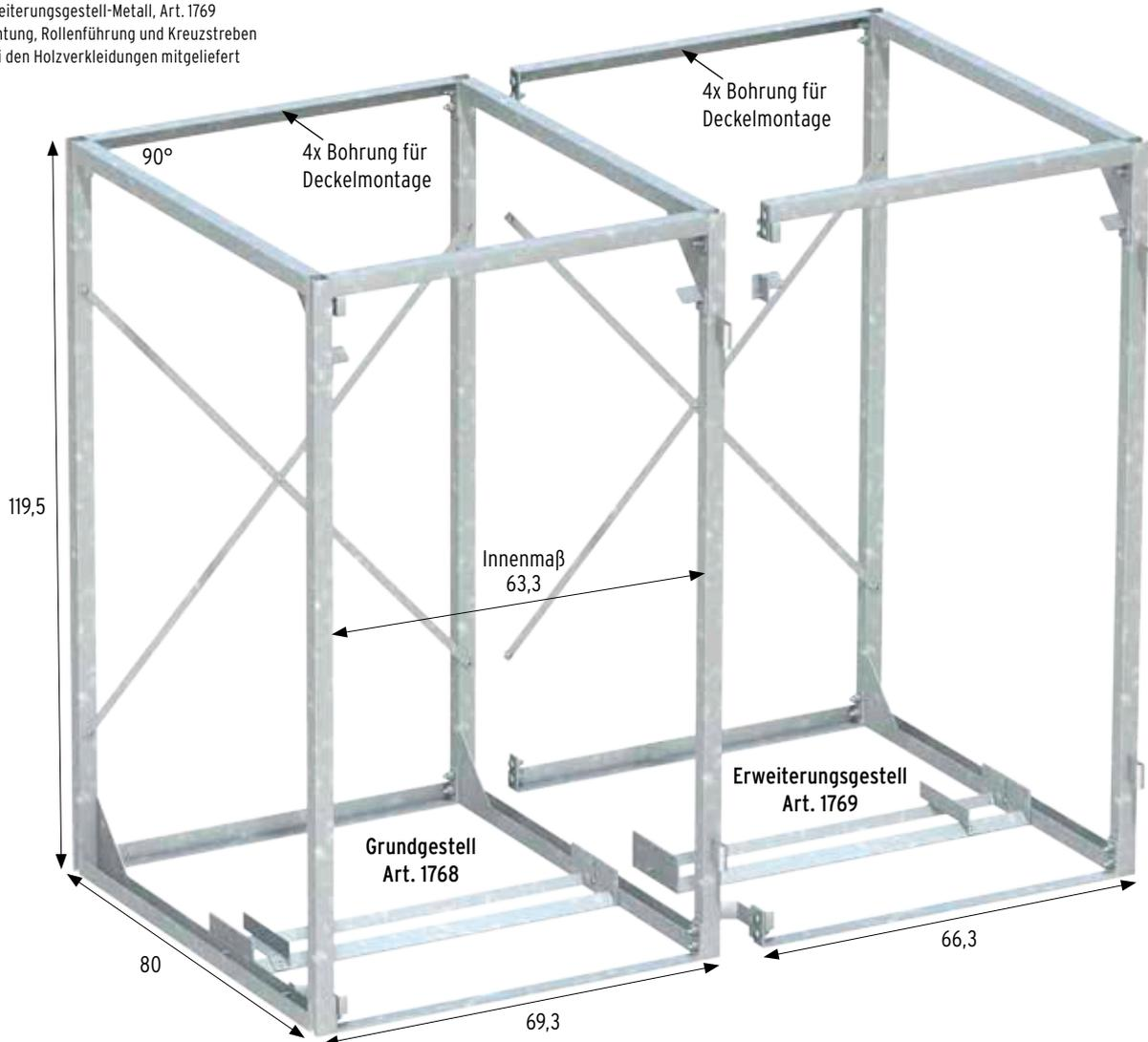
Das *Innenmaß* ist das Maß zwischen den Metallrahmen und ausschlaggebend für die maximale Tonnenbreite.
