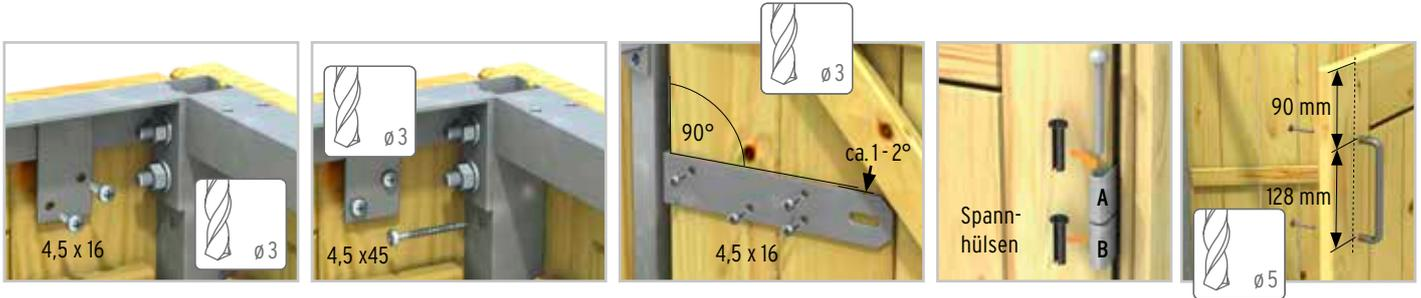
Rückwandmontage: 6x Flachverbinder, Seitenwandmontage: 4x Flachverbinder und 8x Schrauben (4,5 x 45).
