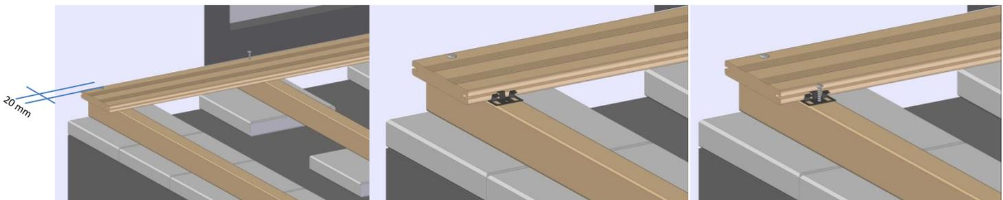
Schneiden Sie für die 2. Reihe eine Diele so ab, dass die Diele mindestens auf 2 Hölzern aufliegt. Das muss auch bei dem letzten Brett auf der anderen Seite genauso gemacht werden. Stecken Sie die komplette Dielenreihe auf die Klammern der vorherigen Reihe und verschrauben die nächsten Klammern mit der Unterkonstruktion.
