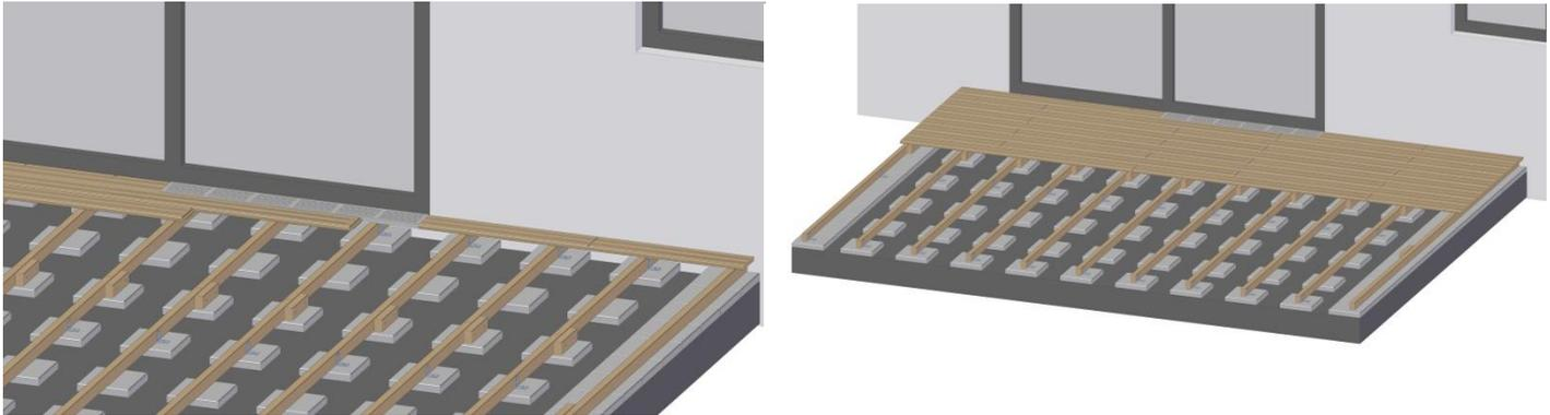
Verschrauben Sie jede Anfang- und Enddiele mit mind. 1 Schraube auf den äußeren Unterkonstruktionen. Das kann schräg durch die Nut oder auch sichtbar von Oben erfolgen. Damit wird ein Verrutschen der Diele minimiert.
