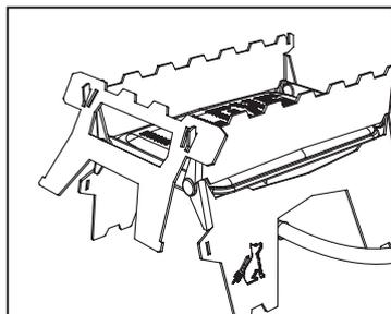
**5.** Um mehr Auflagefläche zu haben, verwende die äußeren Schlitzte bei der Montage. Bei kleineren Gefäßen kannst du die inneren Schlitzte verwenden.
