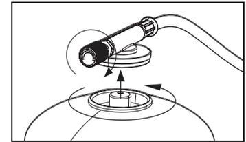
1. Verschließe den Gashahn mit einem handfesten Zudrehen nach rechts (↻), bevor Du die Gaskartusche löst.
