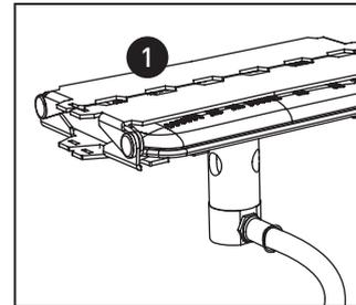
1. An der Boostereinheit (1) mit Brenner sind sowohl die Auflagefläche (2-teilig) als auch die Standfüße montiert, diese müssen nun aufgeklappt werden.
