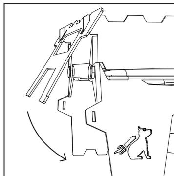
**6.** Klapse nun das Seitenteil (3) nach unten, bis es komplett auf dem äußeren Haken der Boostereinheit liegt. Bringe das zweite Seitenteil (3) auf der gegenüberliegenden Seite der Boostereinheit genauso an.
