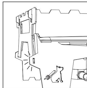
**7.** Klapse nun die Standfüße erst leicht nach außen, damit du diese auf die dafür vorgesehenen Haken der Seitenteile (3) schieben kannst. Drücke dann die Standfüße wieder nach innen um die Seitenteile (3) zu arretieren.
