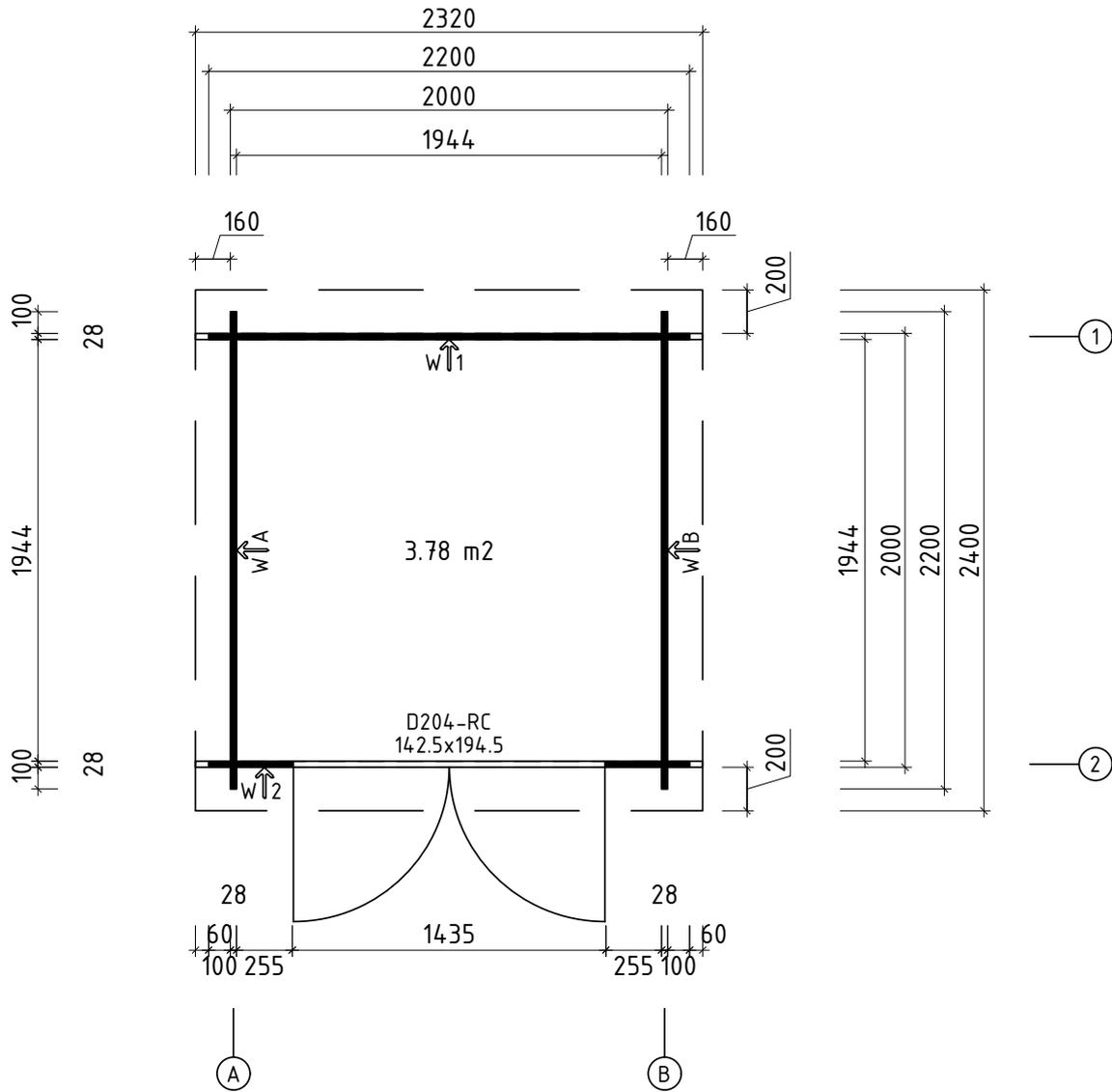
**Wir empfehlen als Fundament für Ihr Gartenhaus eine vollflächig festgegründete, gepflasterte oder betonierte Fläche. Wahlweise ist auch ein Punkt- oder Streifenfundament möglich.**
